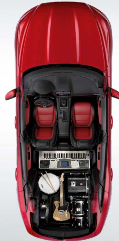
Dry: объем определен путем измерения с использованием твердых блоков (200 мм x 50 мм x 100 мм), отвечающих требованиям VDA. Wet: объем определен путем моделирования заполнения багажного отделения жидкостью.
